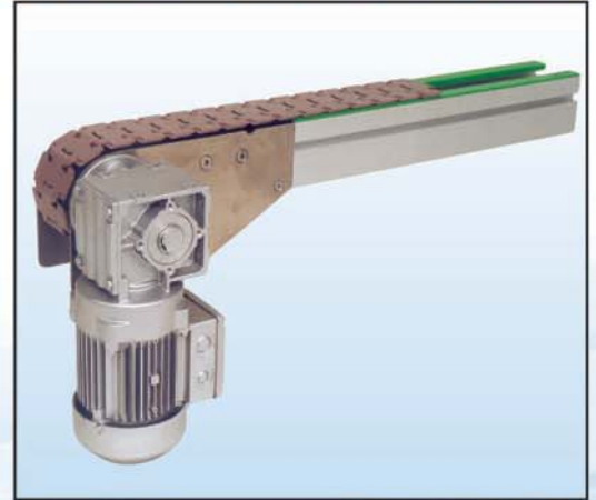
Antriebsstation mit Aufsteckgetriebe (Hohlwelle), 300 mm lang, Bauhöhe 160 mm
